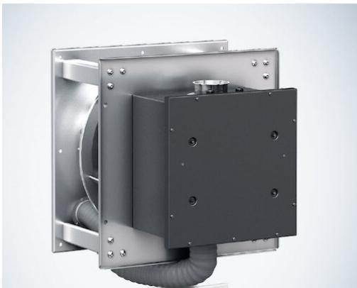
Fläkt konstruerad för frånluftinstalltioner i professionella kök. Tillskillnad från en normal radipac-fläkt har man här flyttat ut motorn från luftströmmen och byggt in den i en separat kapsling som skall ventileras med ren luft. Den passerar då förbi motorn och ventileras ut på sugsidan.
